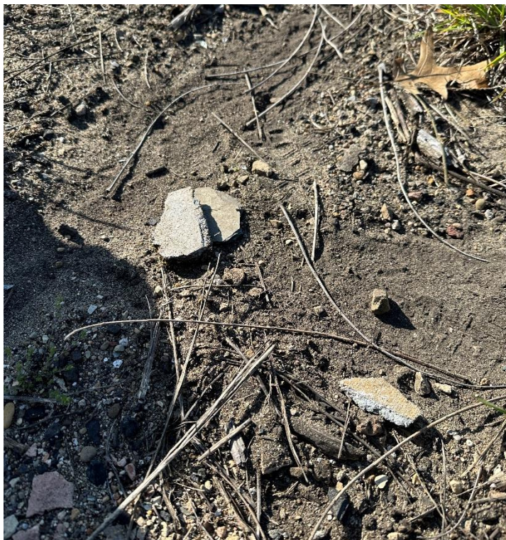
Imagen 2: Los escombros y materiales con asbesto del sitio probablemente provienen de edificaciones antiguas que se demolieron de forma incorrecta.
